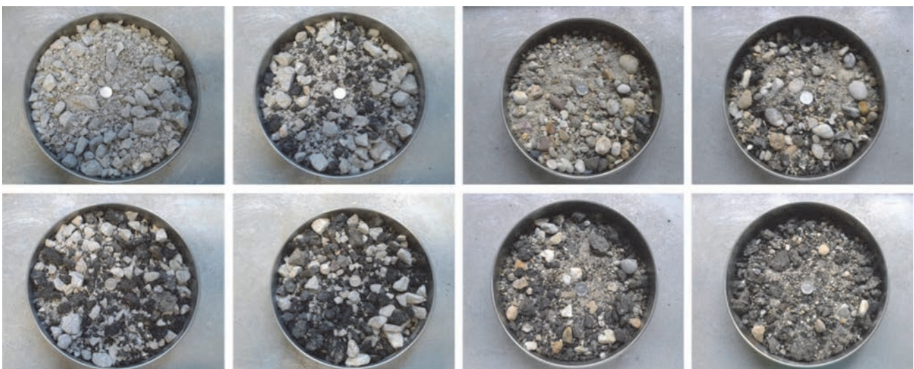
Slika 2. Mješavine recikliranog asfalta i vapnenca (lijevo) te šljunka (desno)
