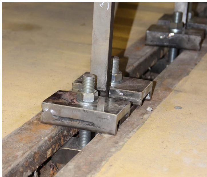
Slika 21. Čelične papuče za upinjanje modela u reaktivnu ploču.
