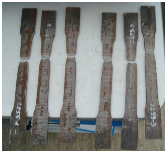
Slika 4.15 – Ispitani uzorci čelika
