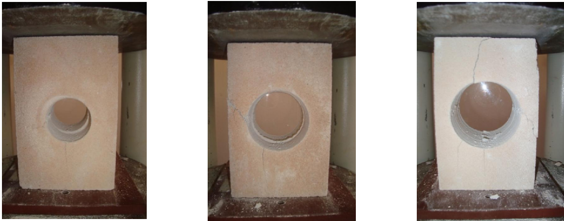
Slika 4.8– Ispitivanje izbušenih porobetonskih blokova
