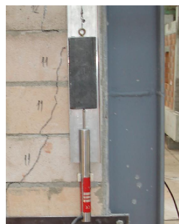
Slika 4.32 - Mjerenje produljenja/skraćenja dijagonala zidanog ispuna
