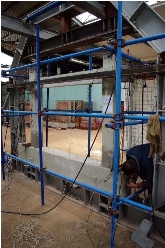
Slika 3.12. Fotografije uzoraka grupe III: a) pri pripremi ispitivanja i b) nakon sloma zidanog ispuna
