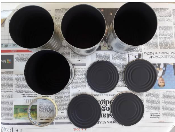
Slika 18. Bojanje unutrašnjosti kamere crnom mat bojom
