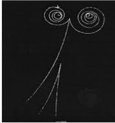
Slika 7. Putanje elektrona i pozitrona u magnetskom polju pomoću mjehuričaste komore [13]
