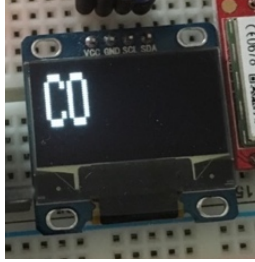
Sl. PD.9. Ispis zaslona pri odabiru tipa plina 4, odnosno očitavanje ugljikovog monoksida u zraku.
