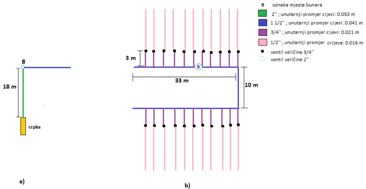
**Sl. 5.2.** Shematski prikaz dijelova sustava navodnjavanja, pri čemu je:
