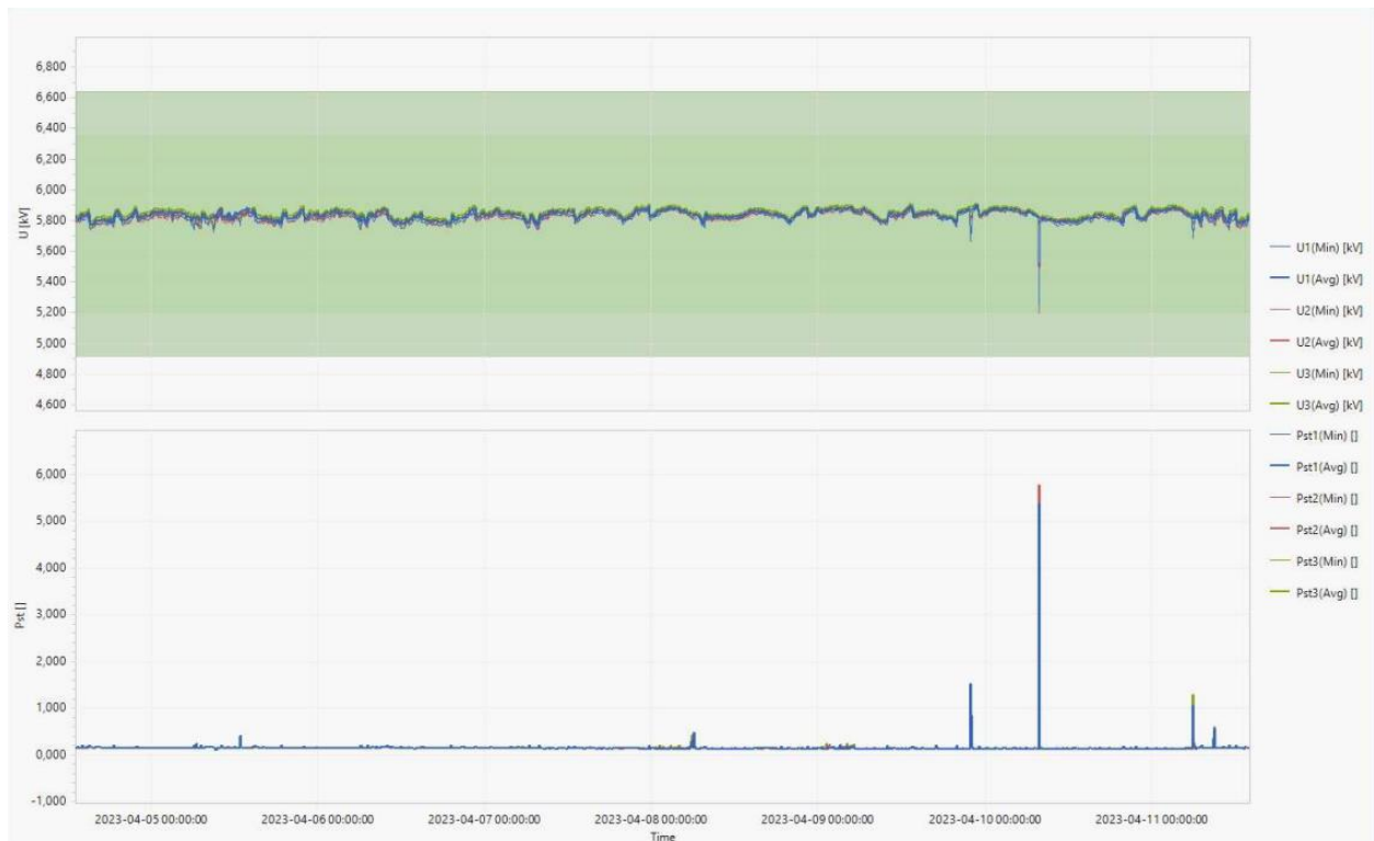
Slika 5.7. 10-minutne vrijednosti kratkotrajnog naponskog treperenja Pst (donji dijagram) te minimalnih 10 minutnih vrijednosti napona (gornji dijagram) u mjernom tjednu [14].
