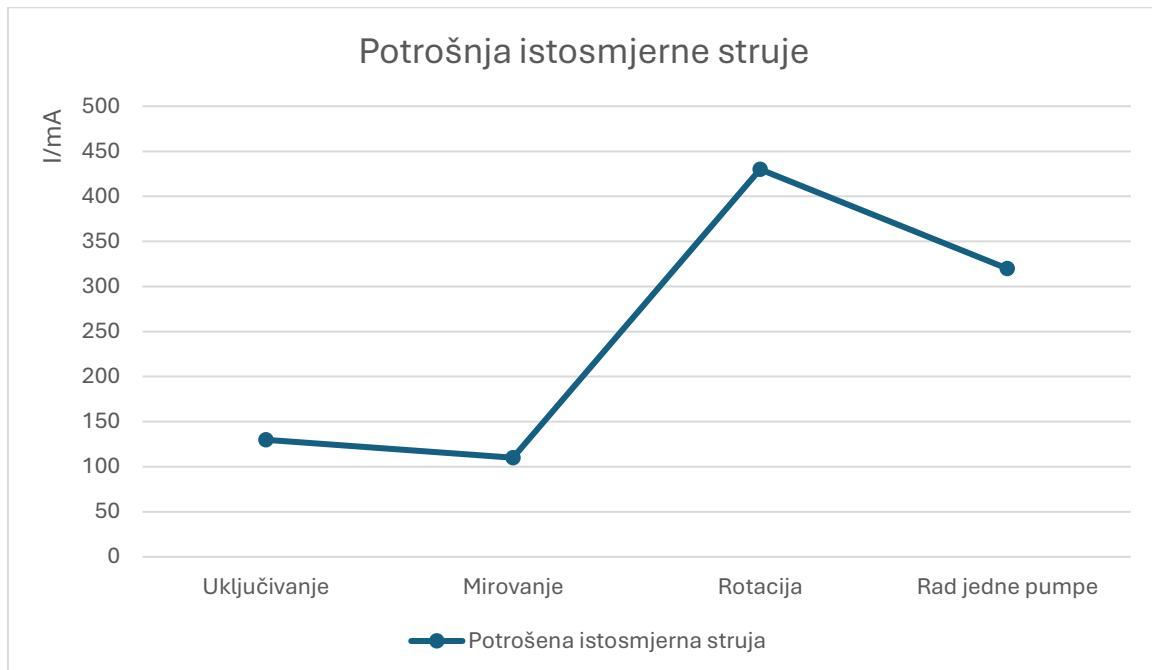
Slika 3.13 Grafički prikaz potrošnje istosmjerne struje sustava
