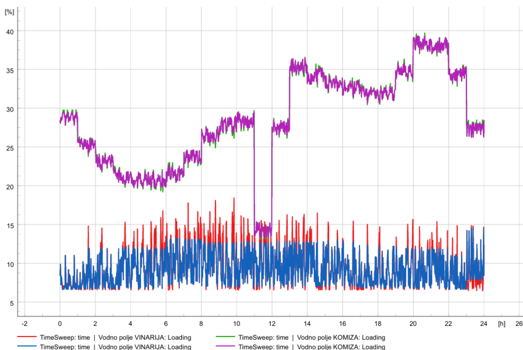
Slika 4.26. Utjecaj integracije elektrane na morske valove na strujno opterećenje glavnih vodnih polja
