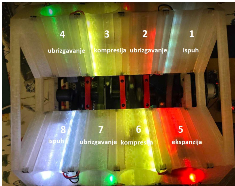
Slika 4.8. Prikaz zajedničkog rada klipova u cilindrima
