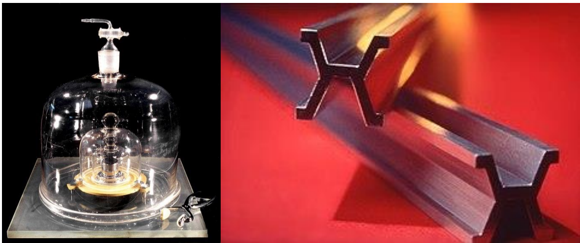
Slika.1 Etaloni kilograma i metra [2]
