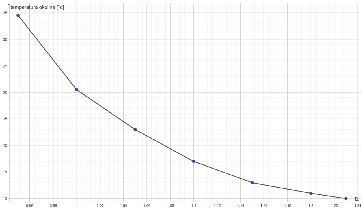
Sl. 8.2. Faktor povećanja otpora baterije ovisnosti o temperaturi okoline[12]
