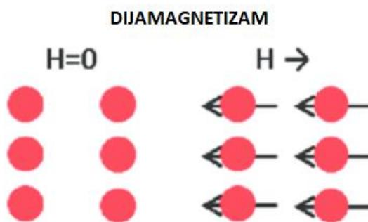
Slika 2.4. Prikaz smjera sile unutar dijamagneta pri djelovanju vanjskog polja [8]
