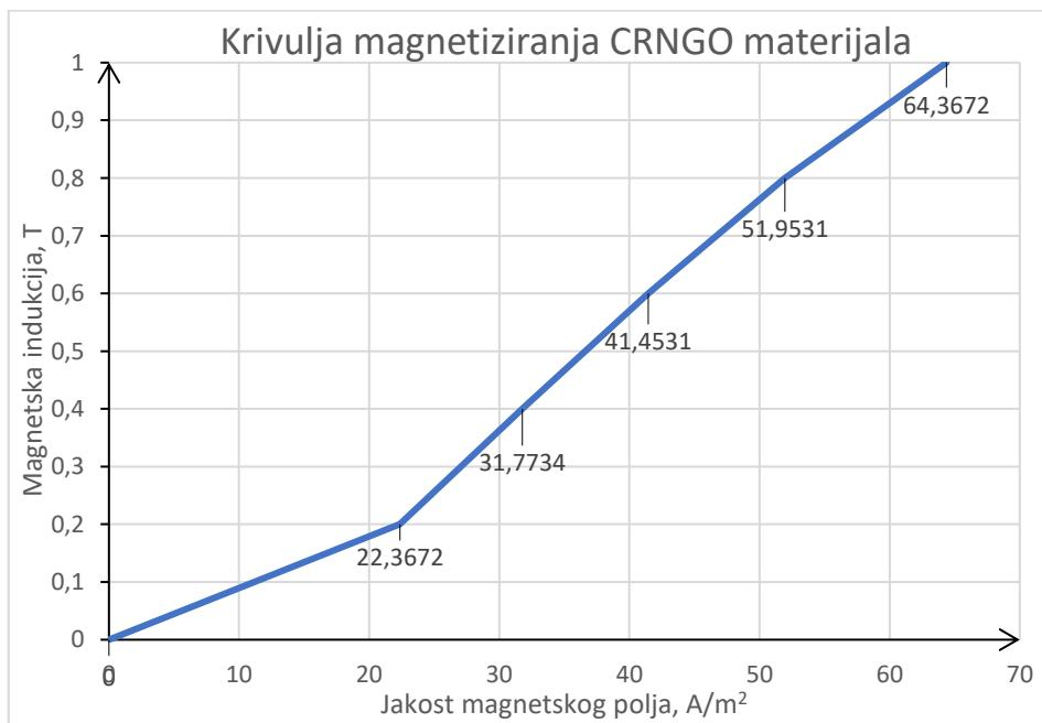
Slika 5.6. Krivulja magnetiziranja CRNGO materijala dobivena rezultatima mjerena
