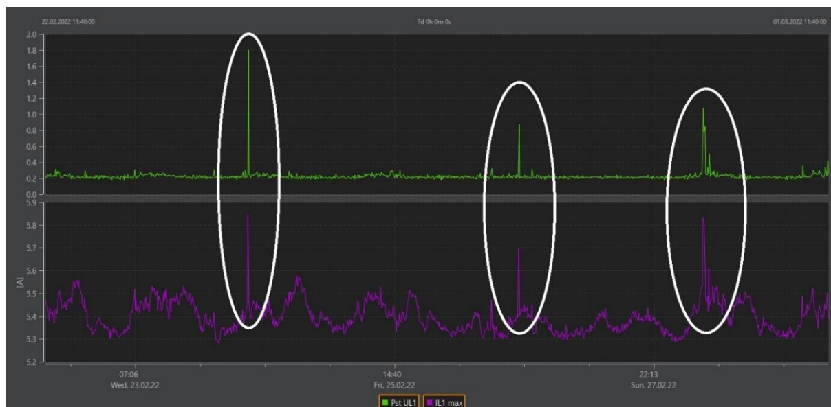
Slika 6.9. Dijagram kratkotrajnih flikera i maksimalne struje u periodu od tjedan dana
