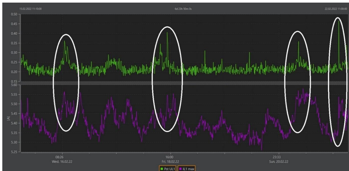
Slika 6.27. Dijagram kratkotrajnih flikera i maksimalne struje u periodu od tjedan dana
