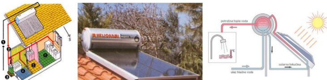
Slika 2.8. Termosifonski sustav s prirodnom cirkulacijom [1]
