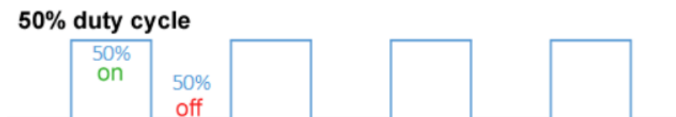
Sl. 3.4. PWM sa duty cycle od 50%.
