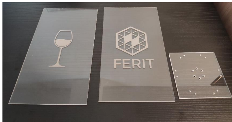
Slika 19. Ugravirane ploče pleksiglasa i stalak za pumpe (lijevo)
