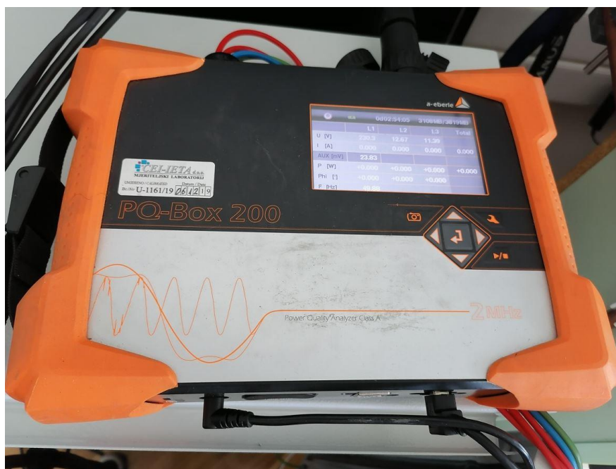
Slika 4-13 Mrežni analizator PQ-Box 200
