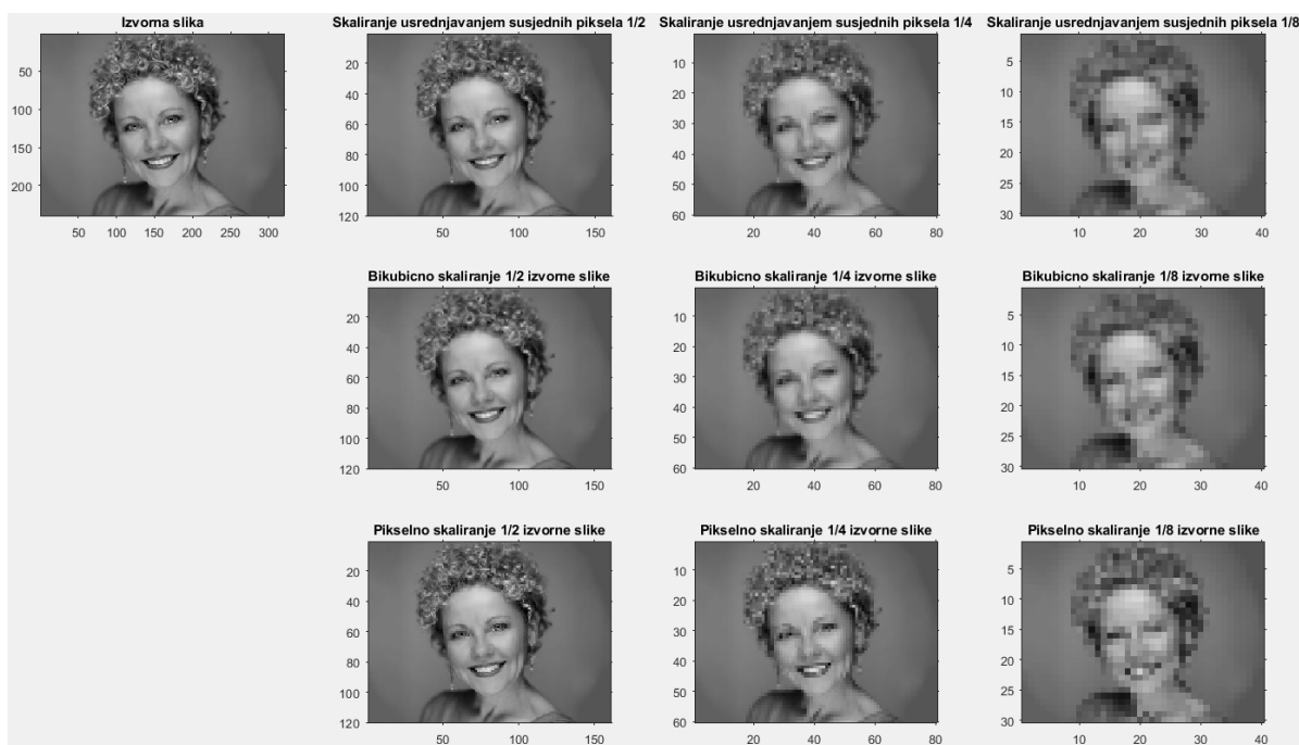
Sl. 3.8. Prikaz rezultata algoritma za skaliranje slike, rađen u MATLAB -u.
