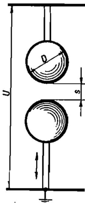
Slika 2.1 Kuglasta iskrišta [5]
