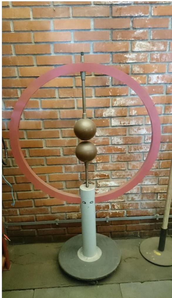
**Slika 2.5** Primjer kuglastog iskrišta
