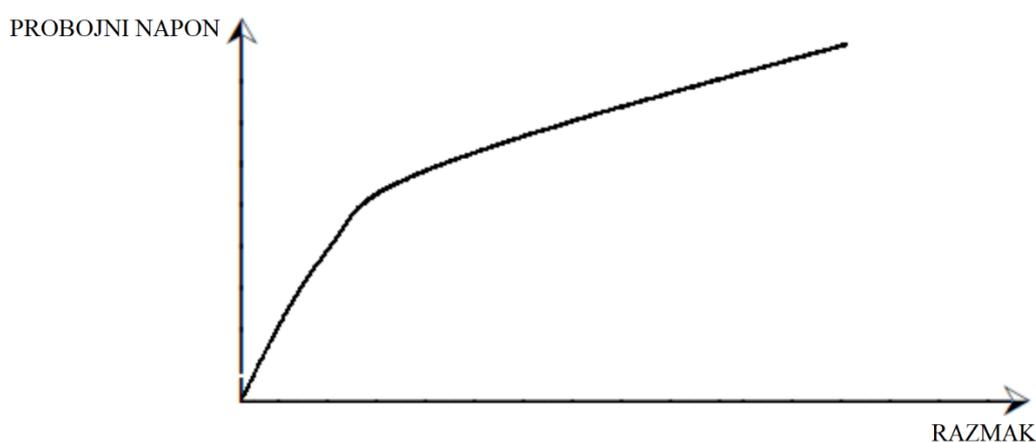
**Slika 2.3** Karakteristika probojnog napona mjenog kuglastim iskrištem [2]
