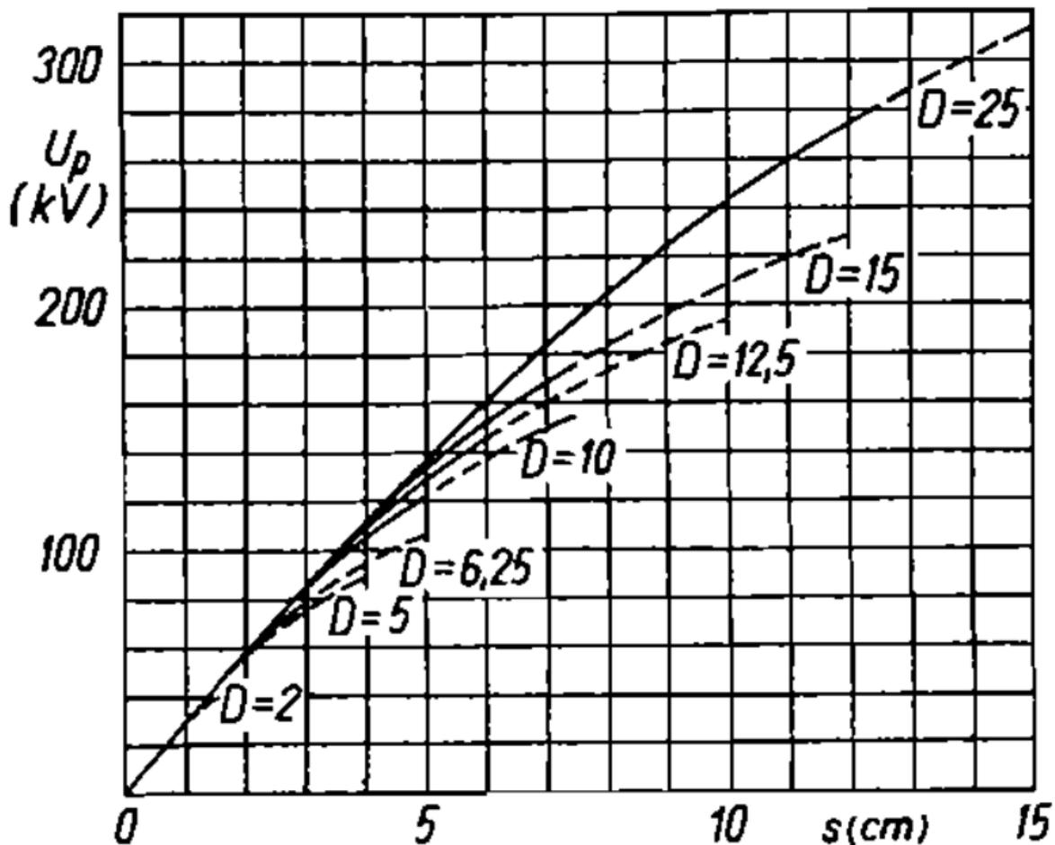
**Slika 2.2** Tjemene vrijednosti probojnih napona u kV za jednopolno uzemljena kuglasta iskrišta kod 20 °C i 101 325 Pa za izmjenični napon, negativni udarni napon i istosmjerni napon oba polariteta [5]
