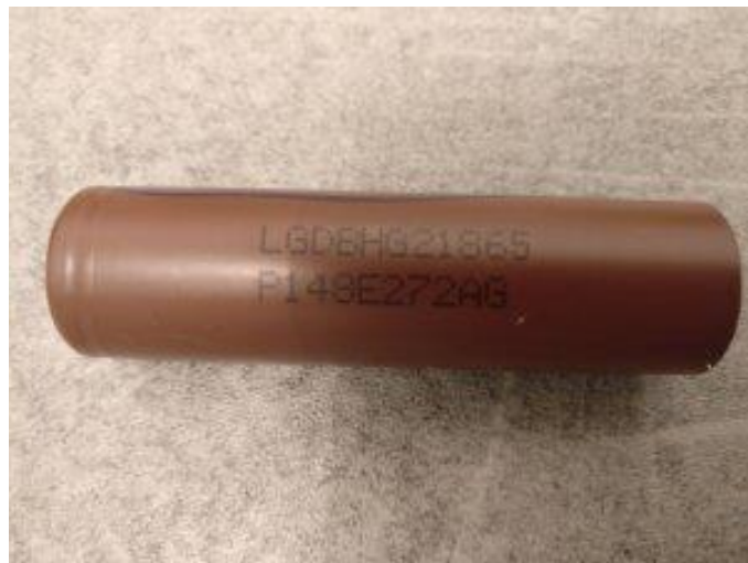
Slika 3.10. Izgled LG 18650HG2 baterijskog članka
