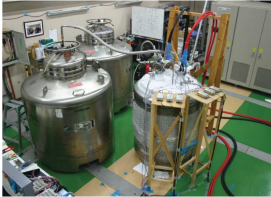
Slika 2.17. Ilustrativna topologija SMES sustava. Tekući helij je pohranjen u spremnicima na lijevoj strani slike, dok se supravodljiva zavojnica nalazi u desnom spremniku.[1]
