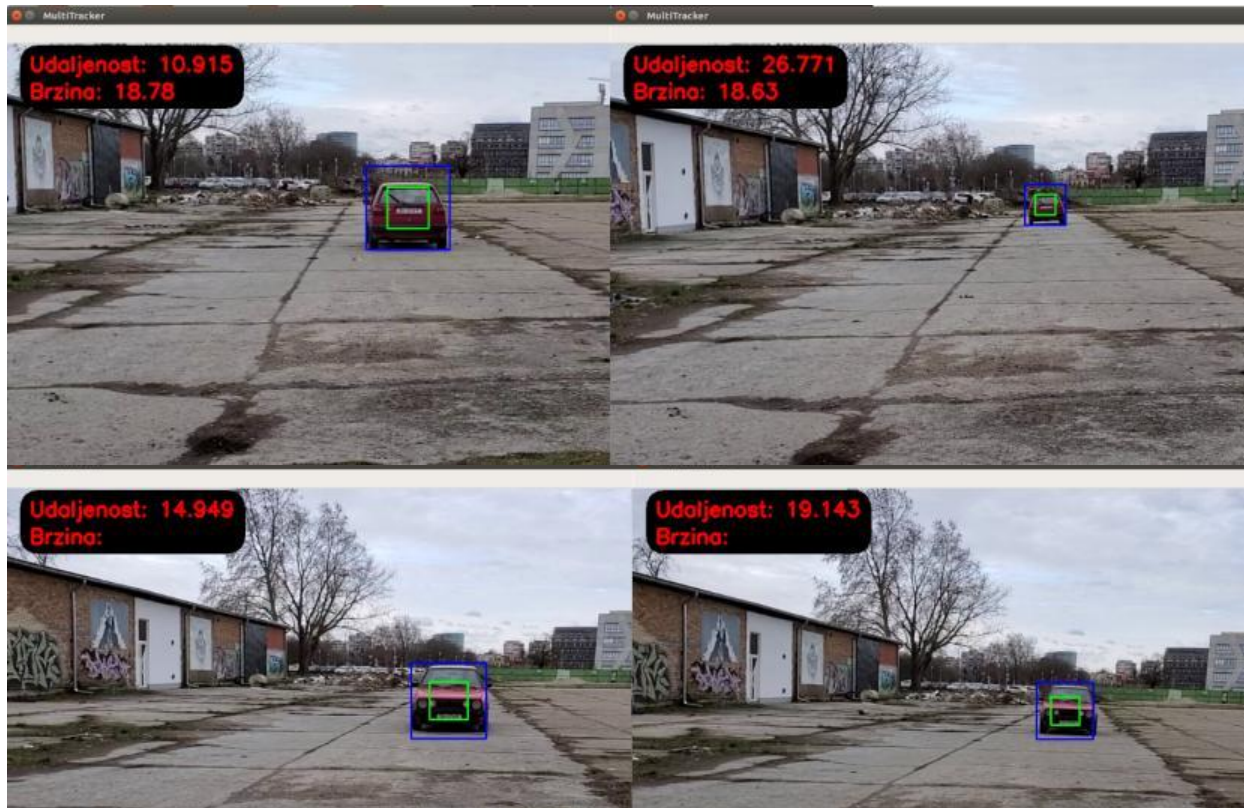
Slika 3.17. Prikaz 4 različite udaljenosti detektiranog automobila (5, 10, 15 i 20 m)
