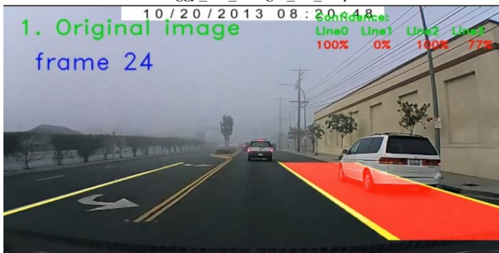
Slika. 4.3. Prikaz okvira netočne detekcije linija na cesti na 24. okviru iz snimke „Foggy_YW_Straight_NT_1.mp4“
