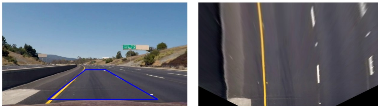
Slika. 3.6. Primjer transformacije perspektive slike: (a) ispravljena slika bez izobličenja kojeg unosi kamera, s označenim ROI-jem, (b) ROI sa slike (a) iz ptičje perspektive, nakon provedene transformacije perspektive
