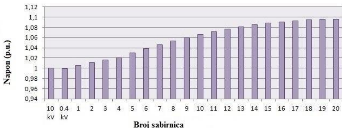
Sl.4.9. Naponski profil za scenarij s 7 kW fotonaponskih sustava proizvodnje i 1 kW potrošnje u kućanstvima, regulirano pomoću invertera fotonapona
