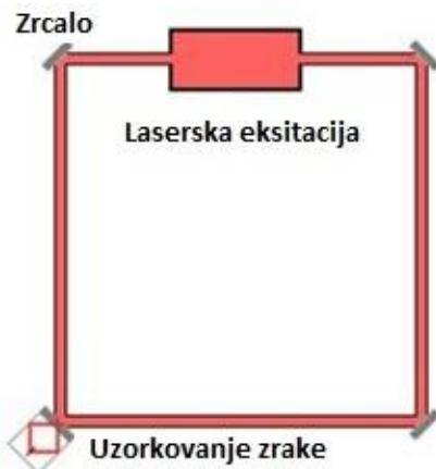
Slika 4.5. Princip rada RLG žiroskopa
