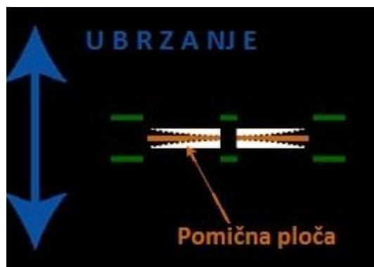
**Slika 3.3.** Kapacitivni akcelerometar
