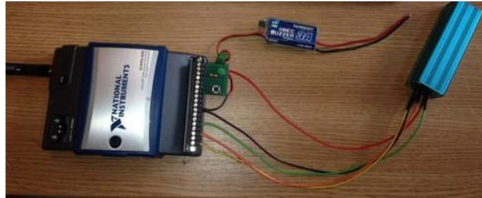
**Slika 7.6.** ADXL330 akcelerometar spojen sa mernim čvorom NI WSN – 3202
