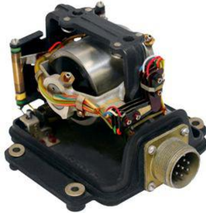
Slika 4.3. Rotacijski žiroskop korišten kao autopilot na zrakoplovima (1950.)
