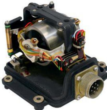
**Slika 4.3.** Rotacijski žiroskop korišten kao autopilot na zrakoplovima (1950.)
