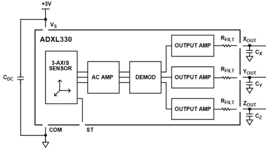
**Slika 7.5.** Funkcionalni blok dijagram mernog sustava ubrzanja ADXL330
