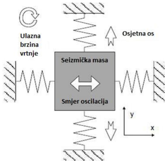
**Slika 4.8.** Princip rada vibracijskog žiroskopa
