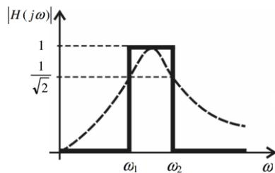
**Slika 2.16** Karakteristika pojednostavljenog propusnog filtra, realna(---) i idealna(- · -)
