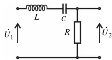
**Slika 2.17** Opći primjer pojedostavljenog propusnog filtra
