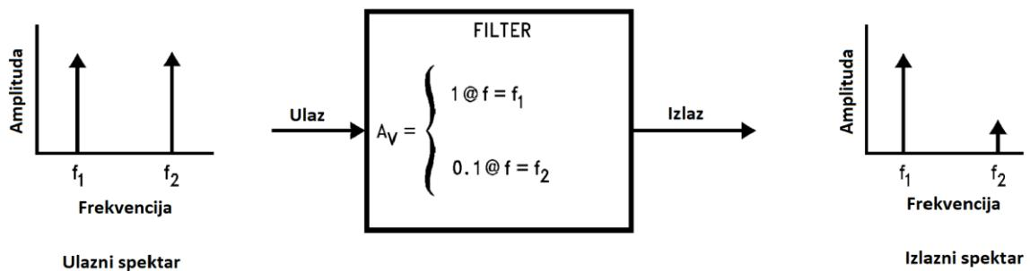
Slika 2.1<sup>1</sup> Filter kao sustav koji djeluje na spektar ulaznog signala
