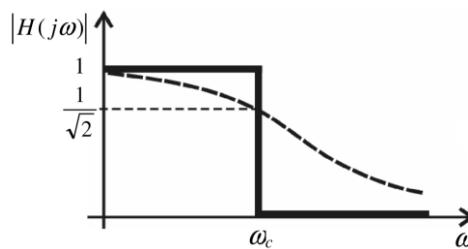
**Slika 2.14** Karakteristika nisko propusnog filtra, realna(---) i idealna(---
