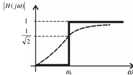
**Slika 2.12** Karakteristika visoko propusnog filtra, realna(---) i idealna(---
