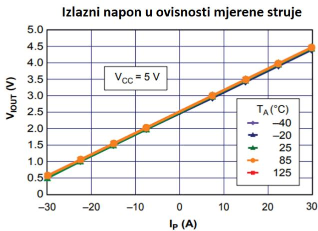
Slika 3.2 Ovisnost izlaznog napona o ulaznoj struji
