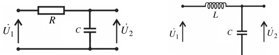
**Slika 2.15** Opći primjeri niskopropusnog filtra
