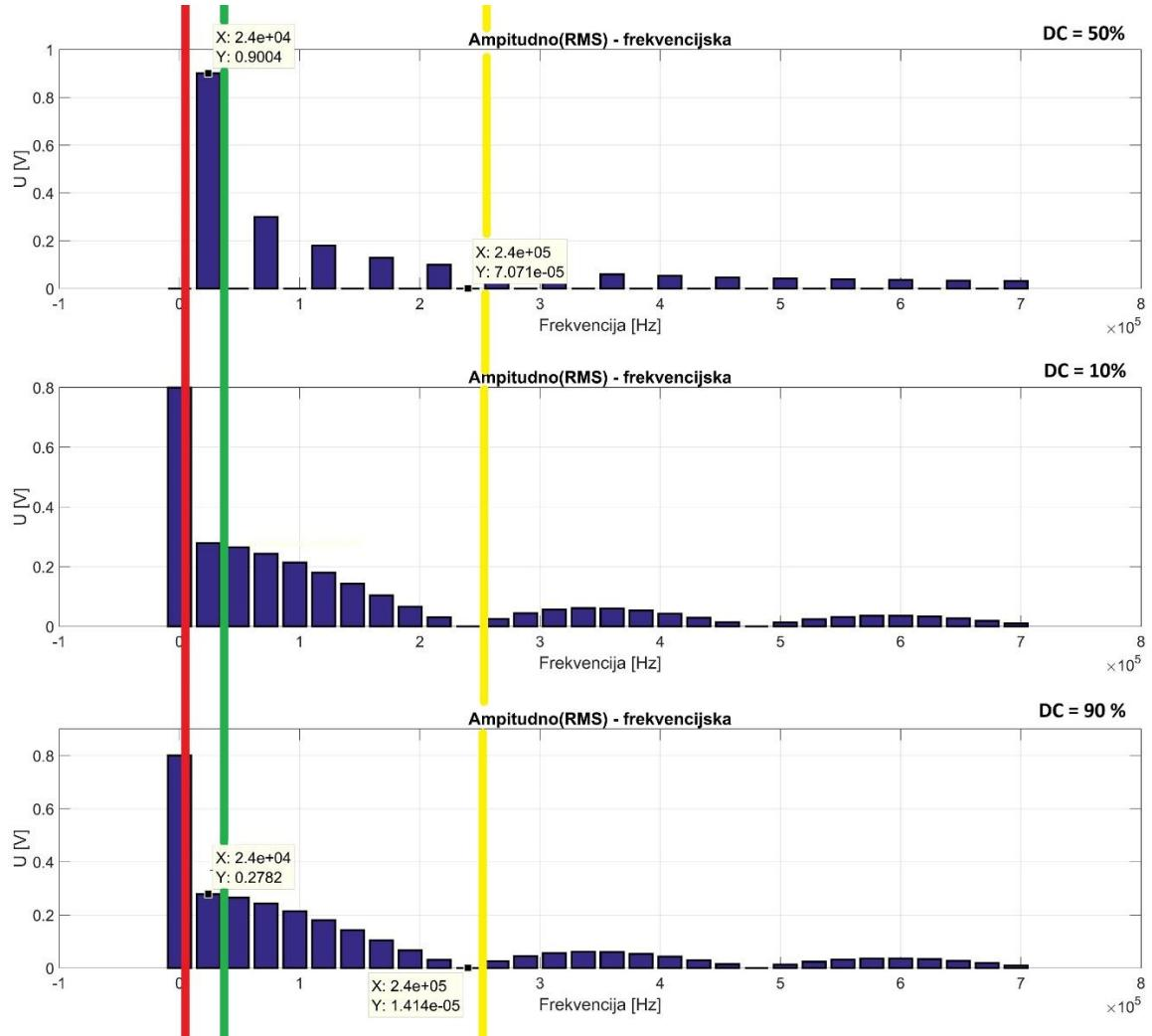
**Slika 3.5** Spektar promatranih signala s označenim graničnim frekvencijama filtera
