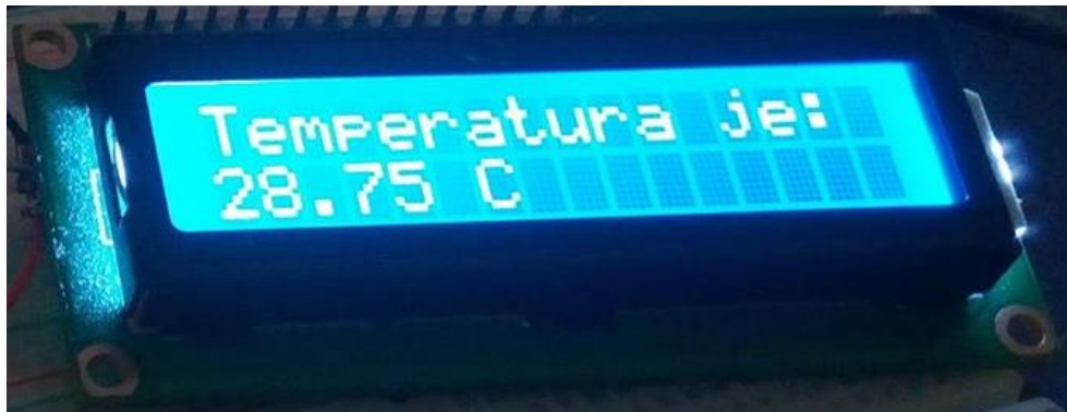
Slika 5.4. Konačan izgled ekrana termometra i ispis koji prikazuje.
