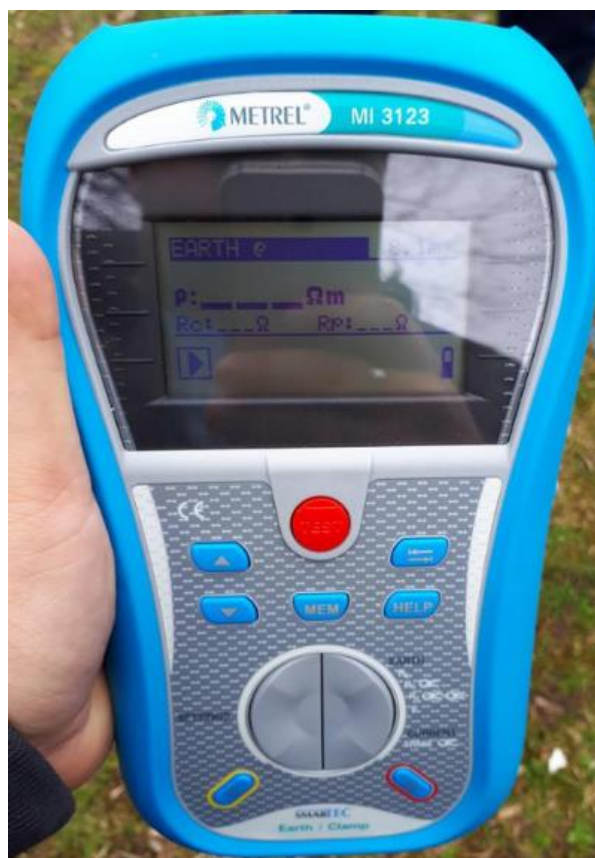
Slika 3.14. Mjerni instrument METREL MI 3123
