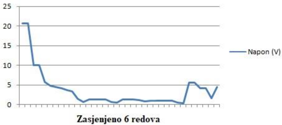
Slika 4.24. Promjena napona pri zasjeni 6 redova modula
