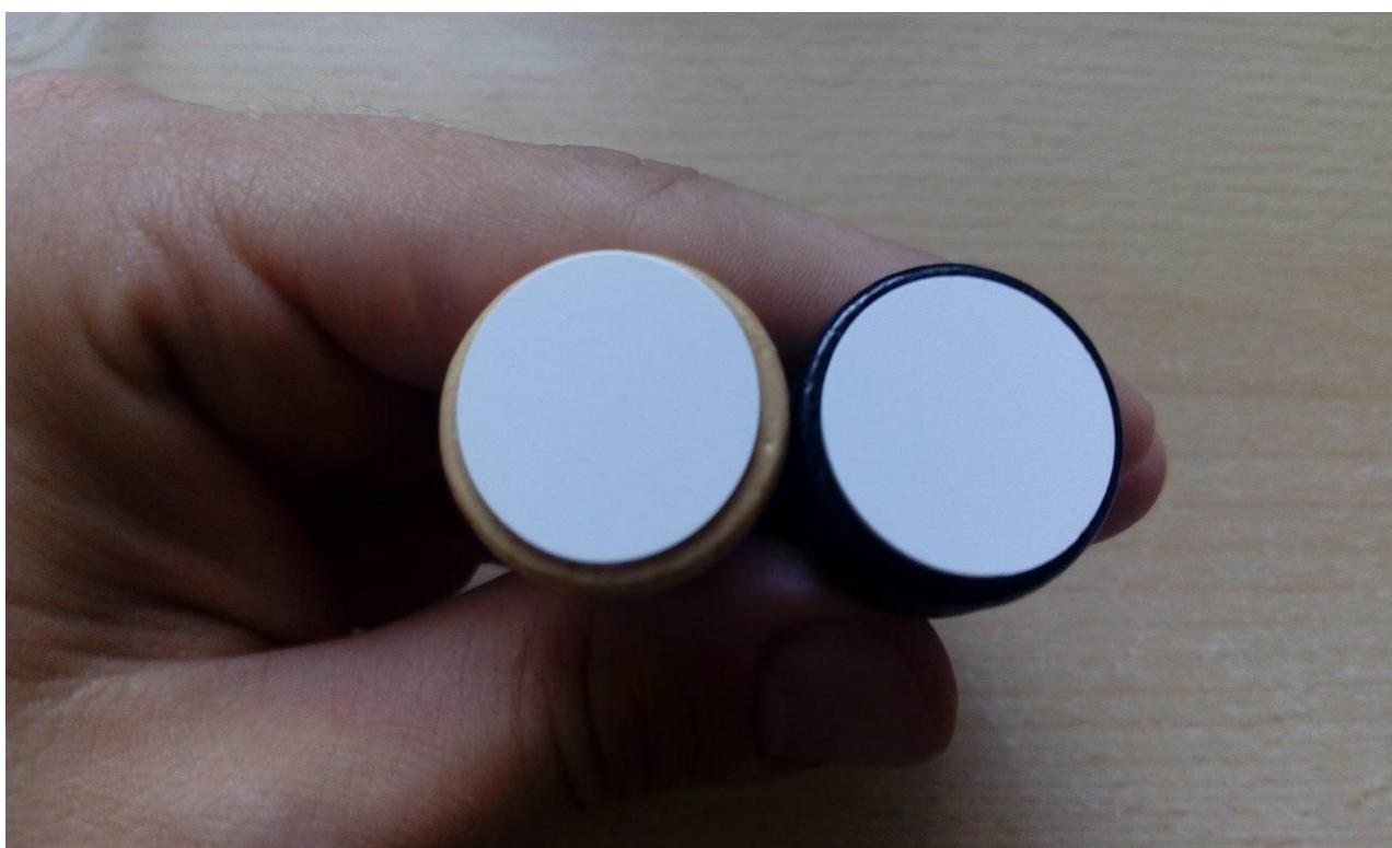
Slika 3.6.:Prikaz korištenih figura s magnetom i tagom nadodanim na dno
