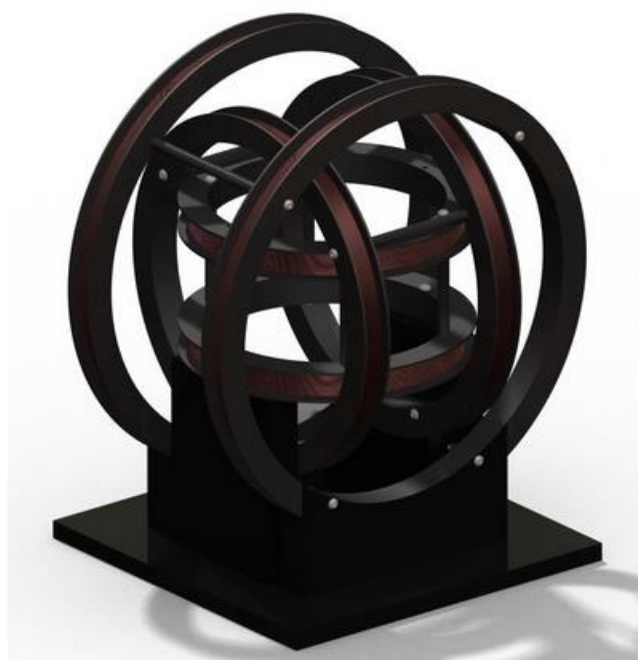
Slika 3.3. Helmholtzov sustav svitaka sa tri para svitaka [13]
