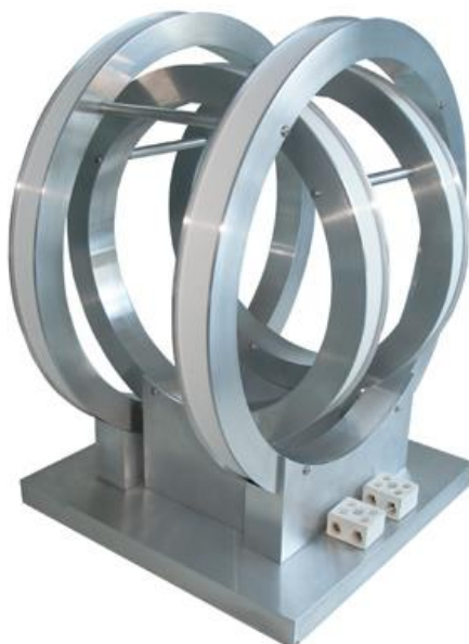
Slika 3.2. Helmholtzov sustav svitaka sa dva para svitaka [12]
