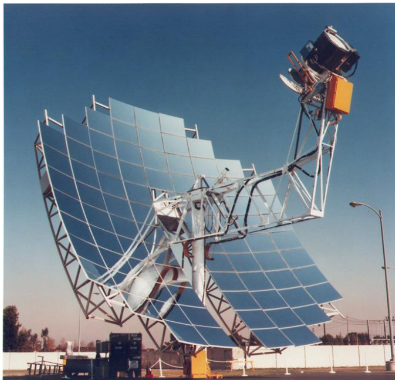
Slika 3.7. Primjer solarnog paraboličnog tanjura [18]
