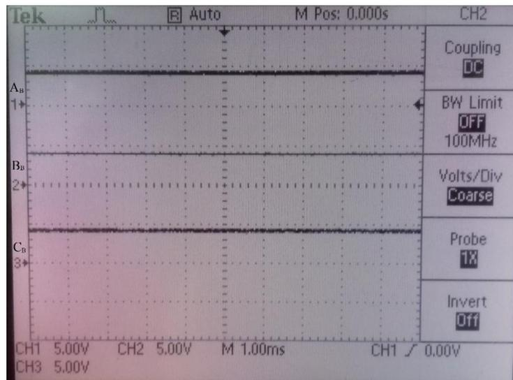
**Sl. 5.7** Upravljački signali N-kanalnih MOSFET-a
