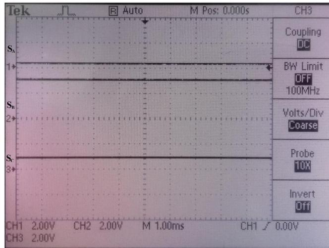
Sl. 5.3 Valni oblici na pretpostavljenim izlazima senzora
