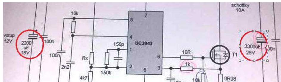
Sl. 5.10. Vrijednosti ulaznog i izlaznog kondenzatora sheme sa slike 5.3
