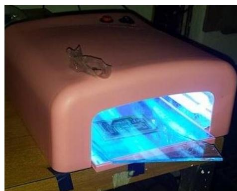
Sl. 2.3. Osvjetljivanje pločice
