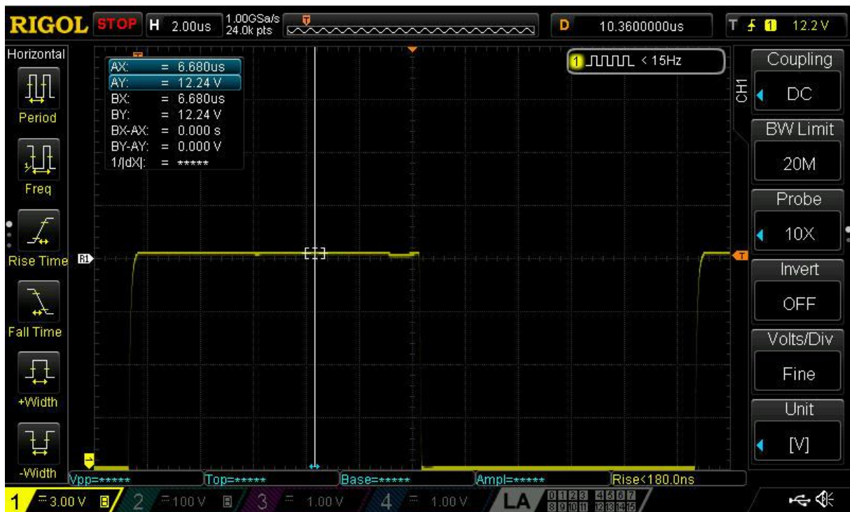
Slika 3.2.7-Signal poslije komparatora za 470pF
