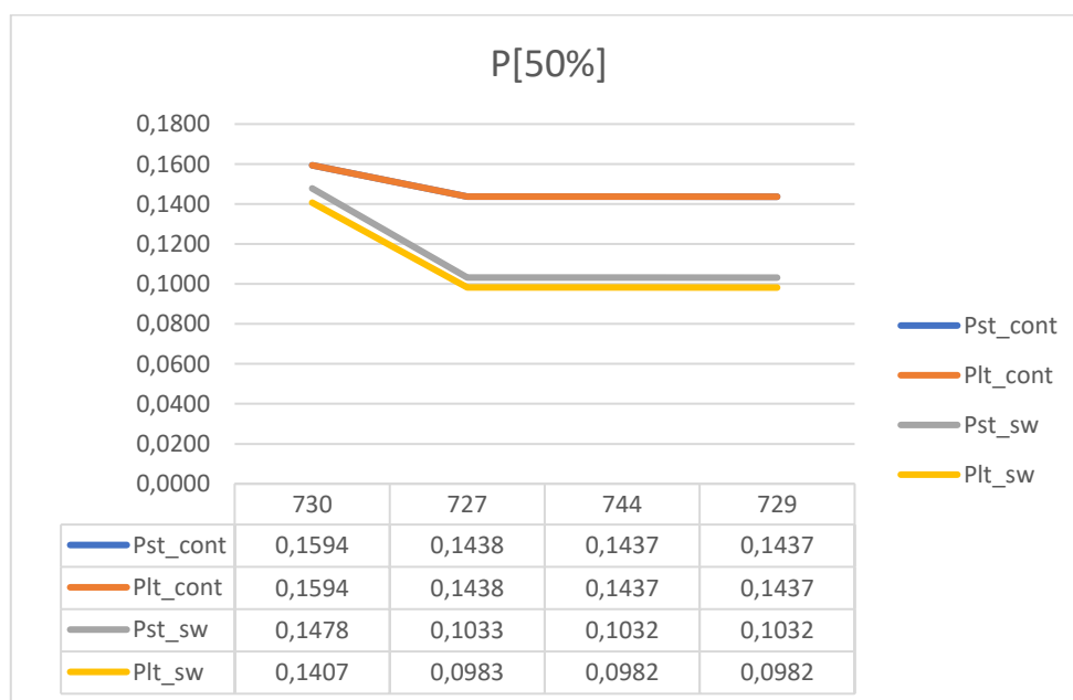
Graf 5.39. Prikaz promjene faktora treperenja na karakterističnim sabirnicama za izlaznu snagu agregata iznosa 50% ukupnog opterećenja
