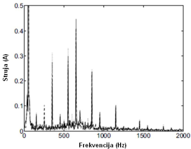
Slika 6.2 Spektar struja grupe od tri vjetroturbine snage 600 kW sa pretvaračem[4]
