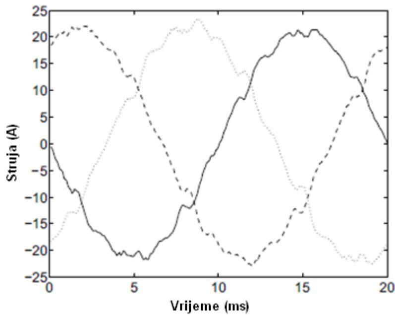
Slika 6.1 Struja tri vjetroturbine snage 600 kW sa pretvaračem[4]
