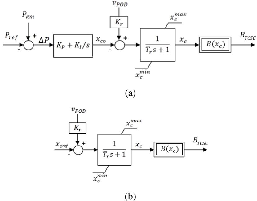
Slika 3.2. Načini upravljanja TCSC-a: (a) regulator konstantne snage; (b) regulator konstantne admitancije. [1]
