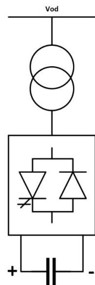
Slika 2.2. Statički sinkroni kompenzator, STATCOM.
