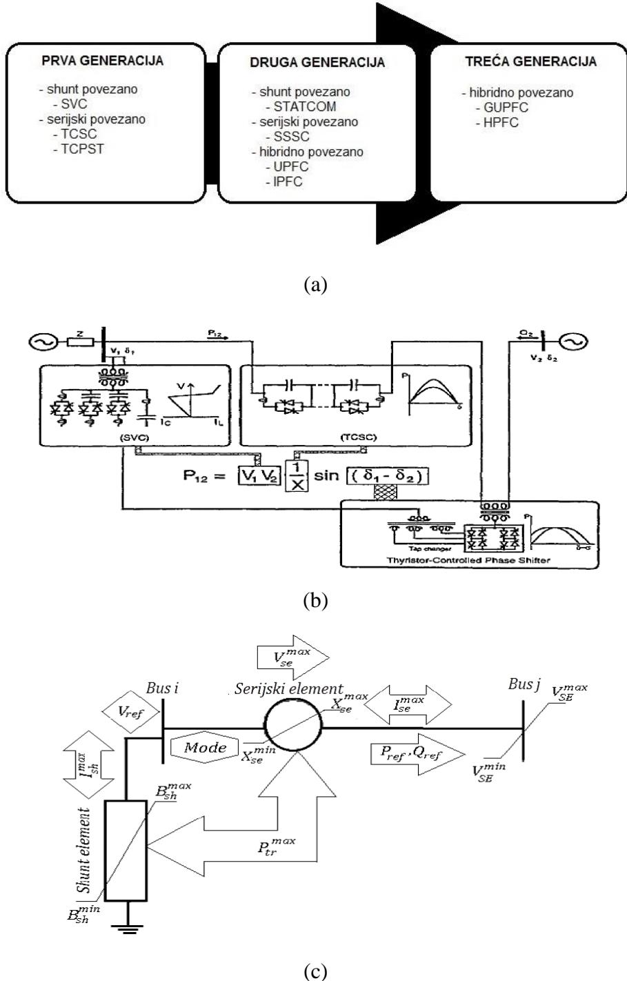
Slika 2.1: FACTS uređaji; (a) klasifikacija, (b) koncept kontrole toka snage koristeći FACTS uređaje (aktivne i reaktivne), (c) opći model FACTS uređaja. [1]
