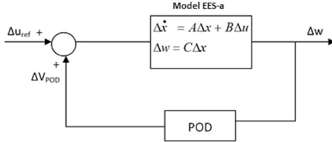
Slika 3.3. Opći prikaz sustava povratne veze s POD-om.[1]
