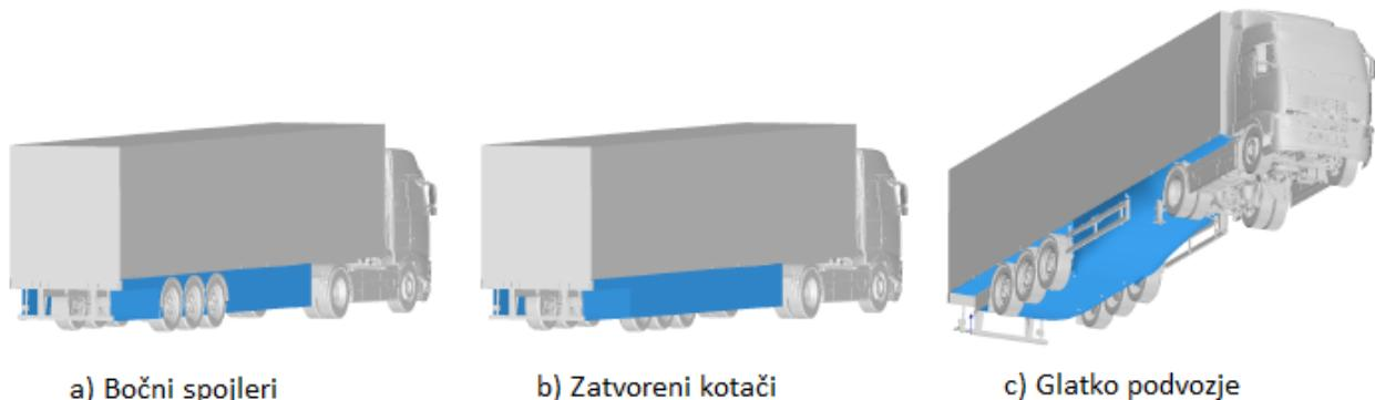
Slika 5.13.Tretiranje podvozja. Izvor [18].
