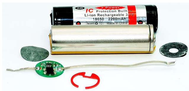
Sl. 3.25. prikaz konstrukcije 18650 baterije. [Izvor: http://www.lygte-info.dk/info/battery%20protection%20UK.html ]
