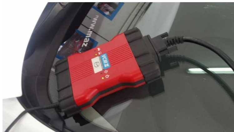
Slika 3.14. VCM II kao veza između automobila i osobnog računala
