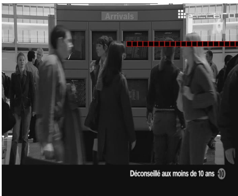
Sl. 4.8. Detektirani pravilni, pravokutni artefakti gubitka paketa
