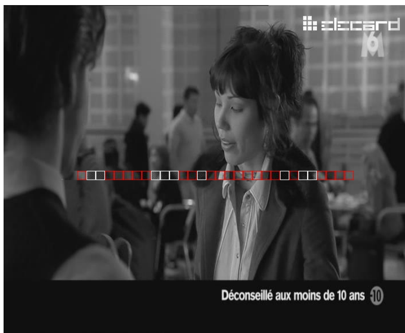
Sl. 4.12. Vertikalno povezivanje makroblokova koji sadrže artefakt gubitka paketa
