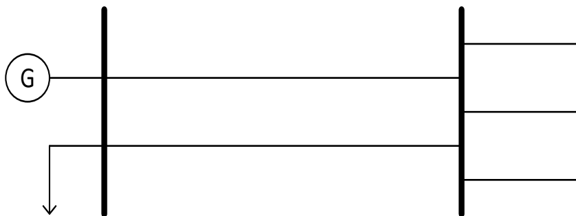
Slika 3.3. Sabirnica s opterećenjem i proizvodnjom povezanom na mrežu preko dva voda [10]
