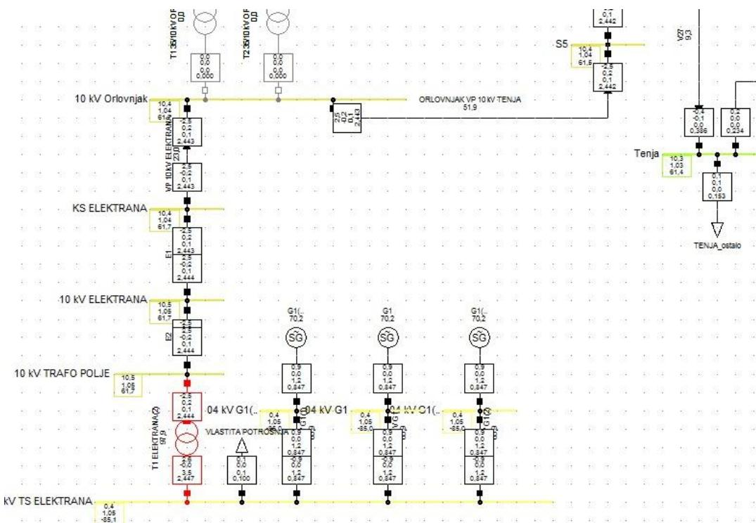
**Slika 5.2.** Opterećenost transformatora pri proizvodnji 2,67 MW
