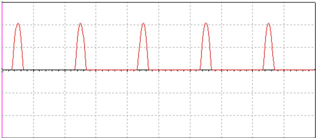
**Sl. 4.5.** Strujni valni oblik kolektorske struje  $I_C$  za sinusnu pobudu amplitude 10 V.
