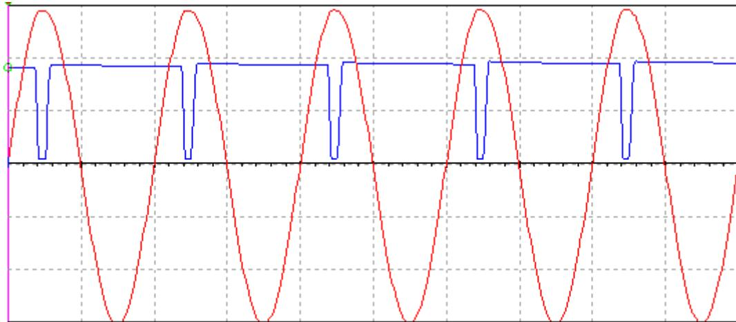
**Sl. 4.12.** Odnos ulaznog i izlaznog signala za sinusnu pobudu amplitude 15 V (pojačalo sa sinkroniziranim radom).
