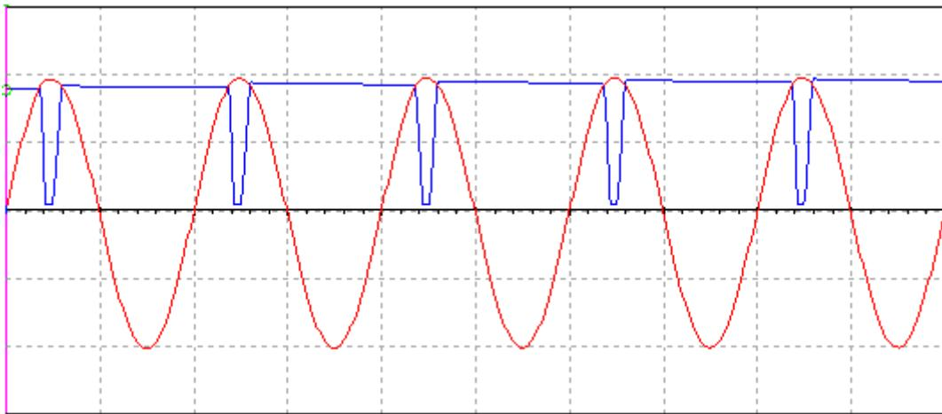
**Sl. 4.10.** Odnos ulaznog i izlaznog signala za sinusnu pobudu amplitude 10 V (pojačalo sa sinkroniziranim radom).
