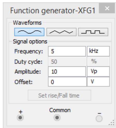
Sl. 4.3. Parametri funkcijskog generatora.
