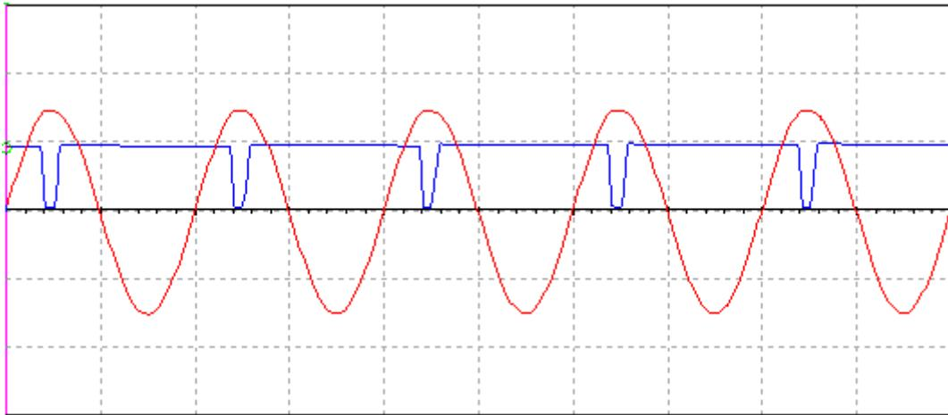
**Sl. 4.14.** Odnos ulaznog i izlaznog signala za sinusnu pobudu amplitude 20 V (pojačalo sa sinkroniziranim radom).
