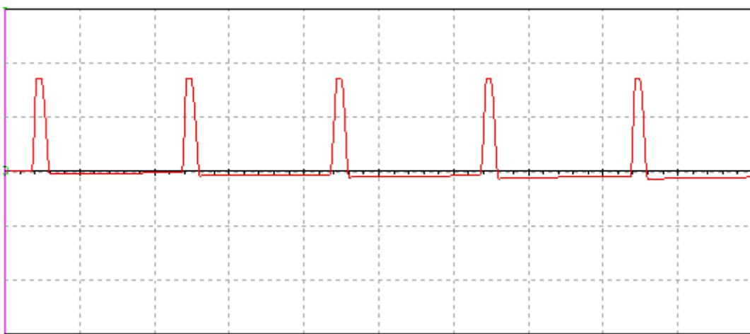
**Sl. 4.11.** Strujni valni oblik kolektorske struje  $I_C$  za sinusnu pobudu amplitude 10 V (pojačalo sa sinkroniziranim radom).
