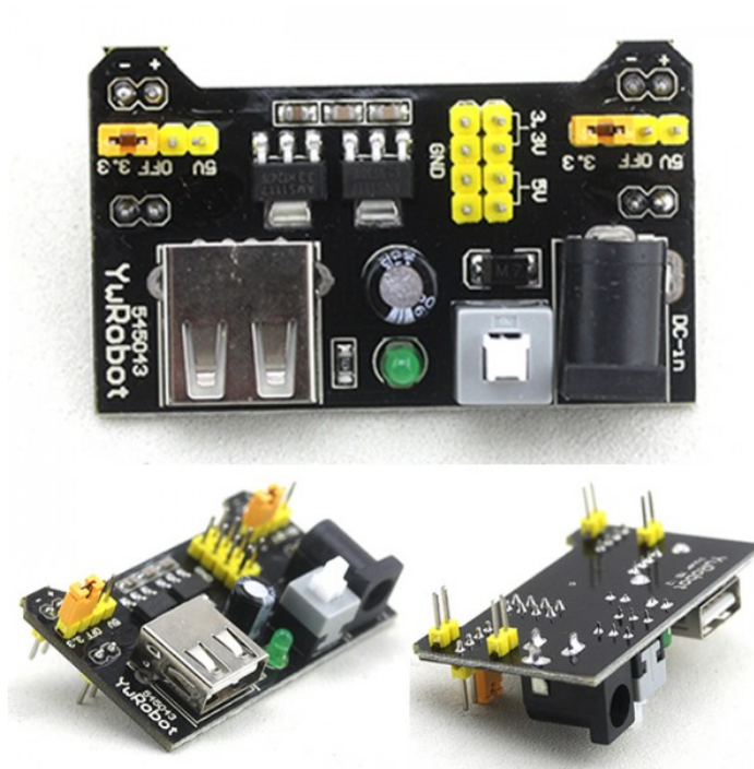
Sl. 2.15. YwRobot 545043 MB102 napajanje eksperimentalne pločice. [26]
