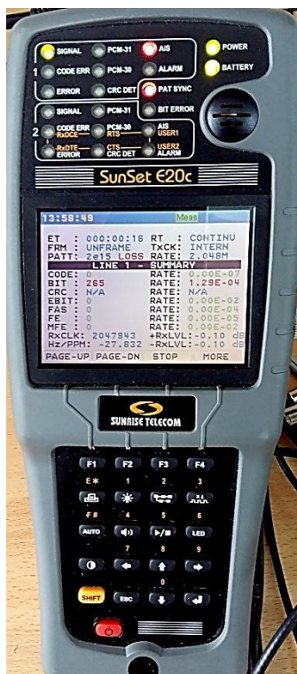
Slika 4.29 Sučelje mjernog instrumenta SunSet E20c pri High BER (AIS) alarmu
