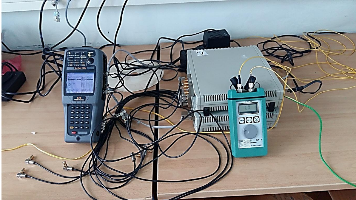
Slika 4.27 Prikaz mjernih instrumenata i uređaja prilikom mjerenja TDM signala
