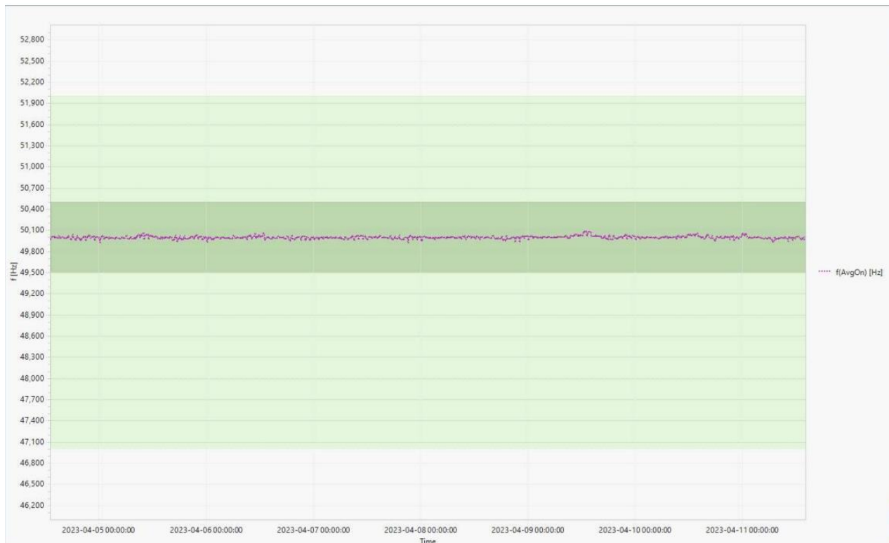
Slika 5.4. 10-sekundne vrijednosti frekvencije u mjernom tjednu [14].
