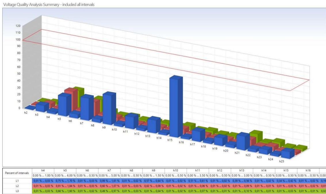
Slika 5.10. Spektar naponskih harmonika u mjernom tjednu [14].
