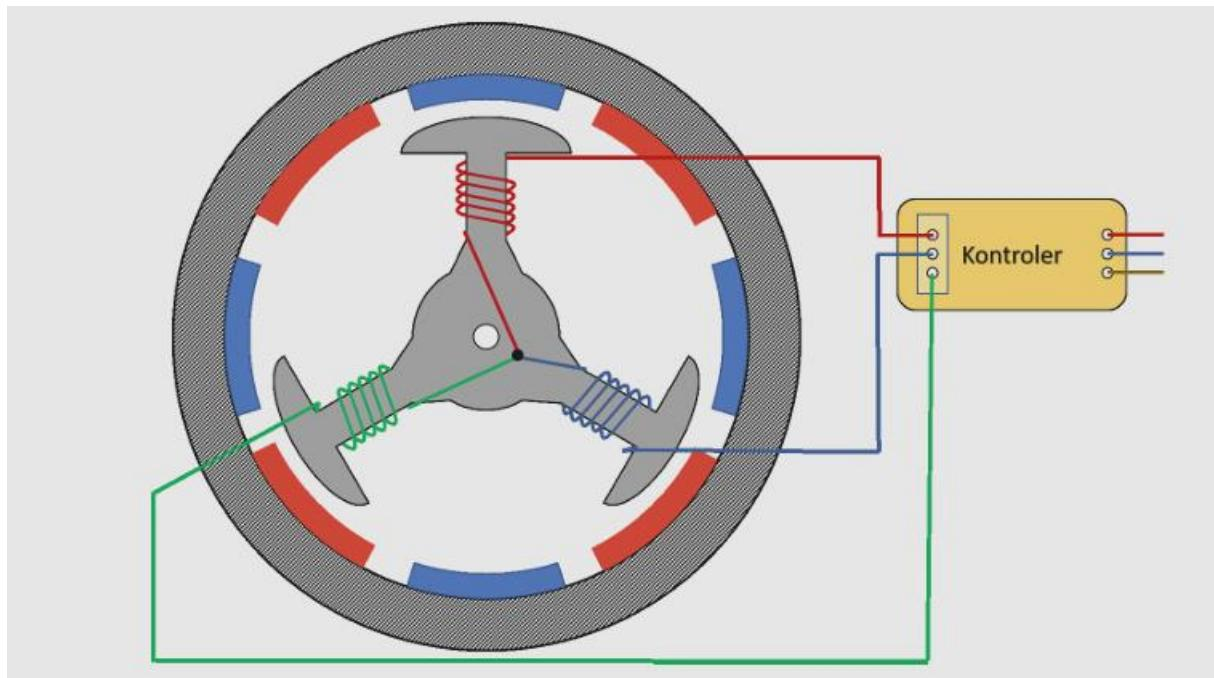
**Slika 2.13.** Pojednostavljeni prikaz BLDC motora sa vanjskim rotorom i unutrašnjim statorom spojenim u zvijezdu [8].
