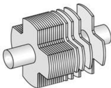
**Slika 2.9.** Poprečno lamelirani rotor sa istaknutim polovima [16].
