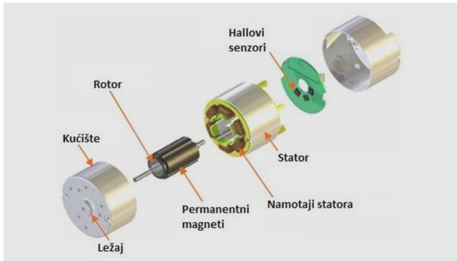
Slika 2.11. BLDC motor sa unutarnjim rotorom (eng. *Inrunner*) [8].
