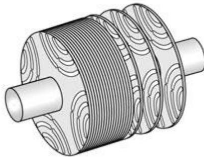
**Slika 2.10.b** Poprečno lamelirani rotor bez istaknutih polova [16].
